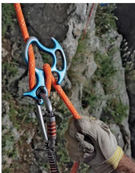
Ma l'aspetto più innovativo dell'OKA consiste nella possibilità di bloccare rapidamente e stabilmente il discensore, fatto che lo rende un dispositivo affidabile e immediatamente utilizzabile anche da persone non molto esperte: asola di bloccaggio e controasola necessarie al bloccaggio dell'*otto* e del *Pirana* sono sostituite da una feritoia in cui passa la corda che viene bloccata con un moschettone.
