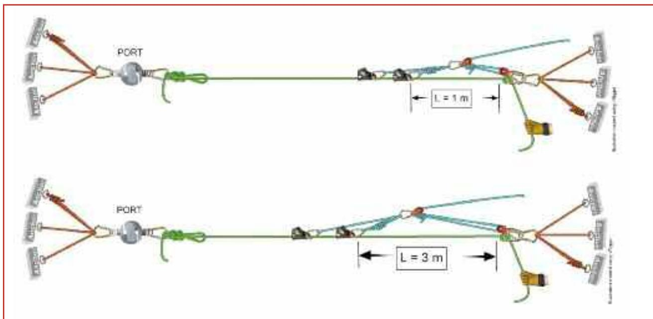
fig. 1. Tensionamento portante teleferica orizzontale (schema) e posizionamento della cella di carico
