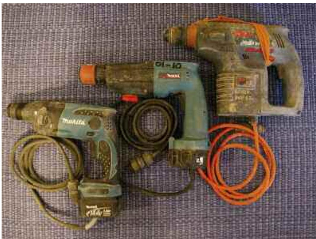
A titolo di esempio, per ottenere circa venti fori di lunghezza 40 centimetri e diametro 8 millimetri, occorrono 12 chilogrammi di batterie al piombo oppure 3,3 chilogrammi di batterie LiFePO Lipotech.
