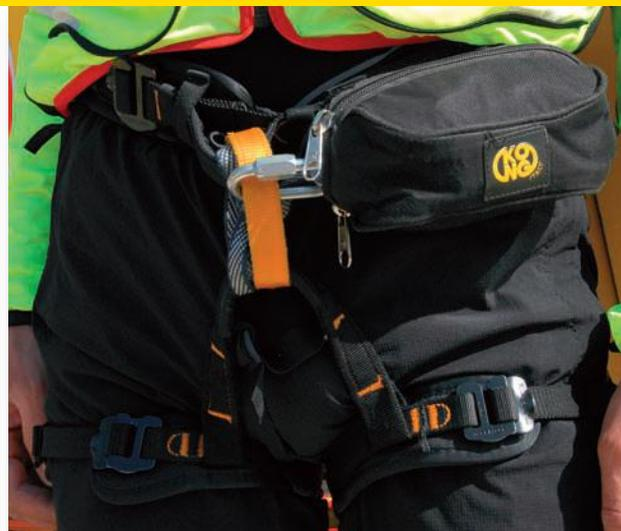
*Particolare dell'imbracatura di sicurezza, con adeguato posizionamento del dispositivo di auto-assicurazione e movimentazione.*
