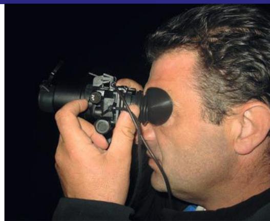
disperse il visore, di fabbricazione statunitense, si è dimostrato di grande utilità, in quanto registra differenze termiche dell'ordine di tre decimi di grado; il suo utilizzo è indifferente se avviene in ambiente diurno o notturno. Decisamente più duttile rispetto i soliti amplificatori di luce. Con un po' di pratica ed addestramento può essere utilizzato, con ottimi risultati, anche durante i sorvoli con l'elicottero.
